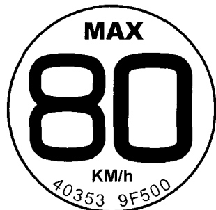
Маркировка малоразмерного запасного колеса, предназначенного только для временного использования
