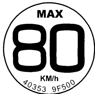
Маркировка малоразмерного запасного колеса, предназначенного только для временного использования
